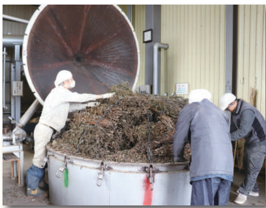
蒸留釜に隙間なく入れていきます
