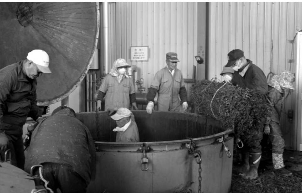
蒸留釜に乾燥させた青しその束を入れていきます
